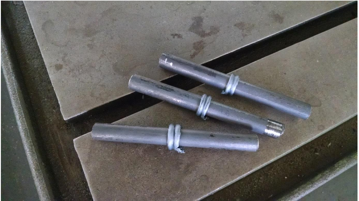
FIGURA 8 – Corpos de prova soldados pelo processo FRW.
