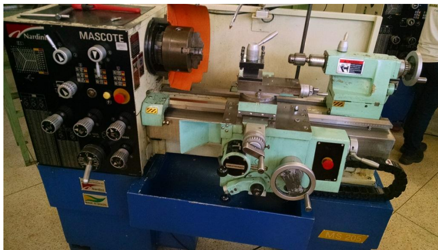
FIGURA 9 – Torno utilizado para soldagem FRW.
